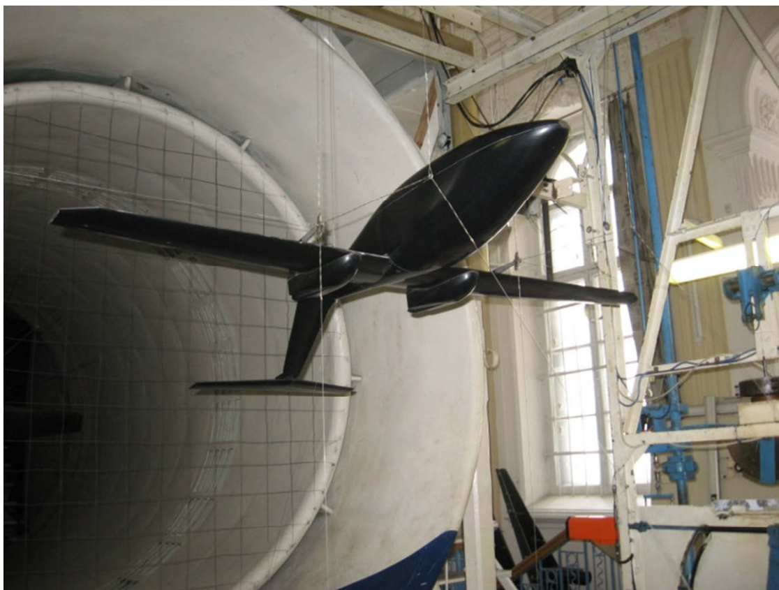
Модель в рабочей части АДТ Т-1К
